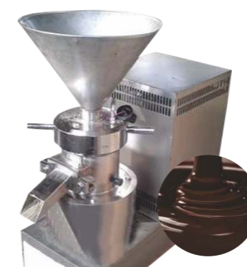
Molino para cacao en pasta: Granulometría mesh 100-200
